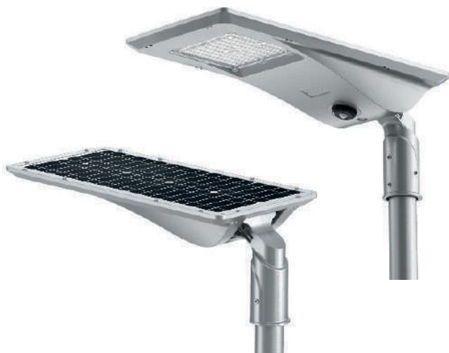
Son el último desarrollo en luminarias autónomas "todo en uno", que incluye un panel fabricado en monocristal con 20% de conversión, una batería de larga duración LiFePO4 que permite ciclos de carga (>2000) y finalmente un sensor de movimiento integrado para optimizar la energía almacenada en la batería. No requiere ninguna conexión a red.
